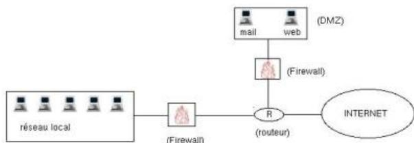
Il dédiera une machine pour le serveur web, une machine pour le serveur de messagerie, deux machines pour le firewalling et un routeur pour assurer la connexion Internet.
