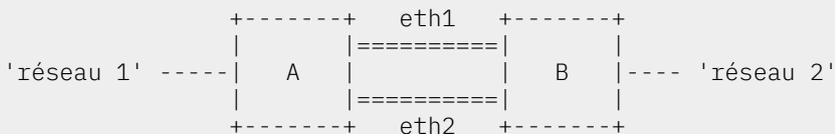
A et B sont des routeurs dont nous supposons qu'ils fonctionnent avec Linux pour le moment. Si le trafic va du réseau 1 vers le réseau 2, le routeur A a besoin de distribuer les paquets sur les deux liens allant vers B. Le routeur B a besoin d'être configuré pour l'accepter. On retrouve la même chose dans le sens inverse, pour les paquets allant du réseau 2 vers le réseau 1. Le routeur B a besoin d'envoyer les paquets à la fois sur eth1 et eth2.
