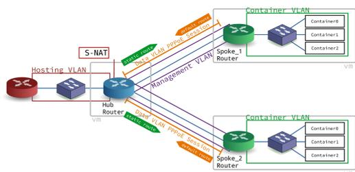
Ce support de travaux pratiques est une illustration d'une topologie réseau classique baptisée Hub & Spoke. Le Hub est un routeur qui concentre tous les flux des routeurs d'extrémités appelés Spoke. Les liaisons entre le Hub et les routeurs Spoke sont point à point et utilisent le protocole PPP. Avec la généralisation de la fibre optique dans les réseaux étendus (WAN), on
