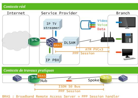
L'objectif de ce support de travaux pratiques est l'interconnexion de réseaux locaux et de réseaux étendus. On utilise une topologie classique baptisée Hub & Spoke dans laquelle le routeur Hub est relié à plusieurs routeurs Spoke via une liaison point à point qui utilise le protocole PPP. Le support physique utilisé pour illustrer la topologie est la technologie RNIS qui permet de transmettre des trames HDLC en couche liaison.
